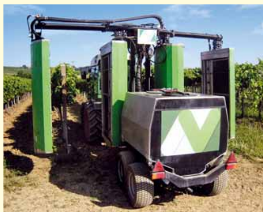
Foto A Macchina per trattamenti TNRG (All Vineyard) a doppio tunnel scavallante con recupero e riciclo del prodotto
